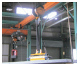
自社内の工作機械周辺でも活躍（吊上マグネット）
