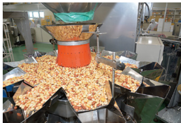
秤型のフィーダー式計量機
