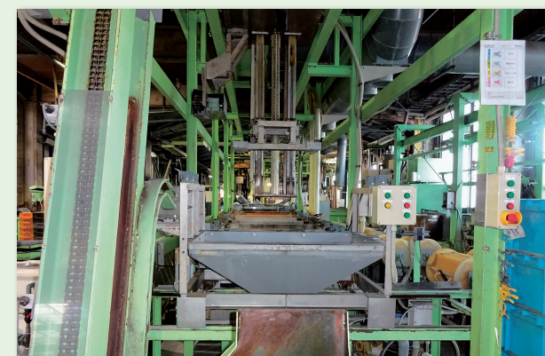
導入したバレル型鍍金装置はきめ細やか被膜を形成
