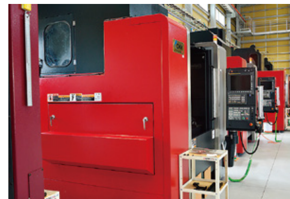
3軸制御で金属加工するマシニングセンタ
