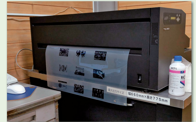
導入されたサーマルデジプレートシステムは製版工程の短縮・効率化につながった
