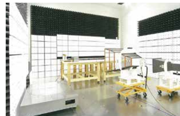
EMC試験を行うための電波暗室
