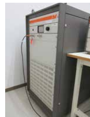
今回導入した高出力増幅器
