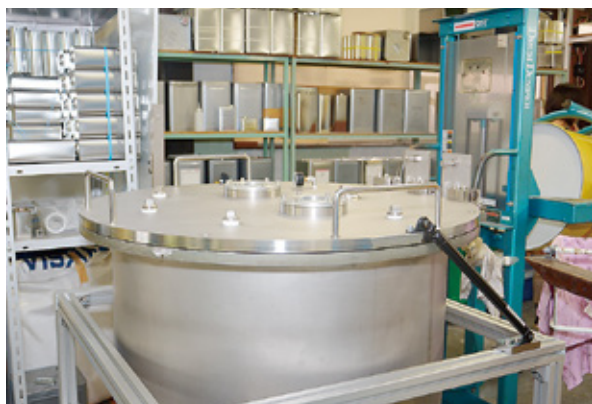
2液混合吐出機。樹脂原液の2液を定量で自動混合
