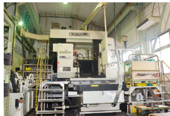
門型平面研削盤。難度の高い大型部品の加工ニーズに対応
