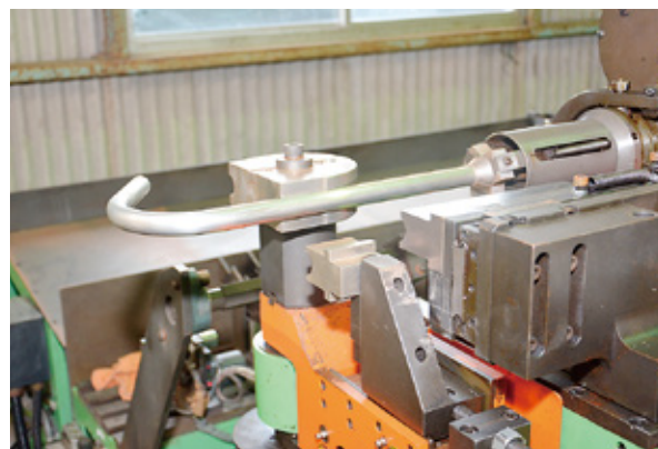
基盤技術であるマグネシウム合金パイプの冷間加工
