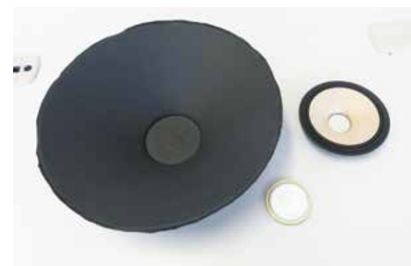
事業によって製造可能となった大型振動板（左）とCNFによる試作振動板（中央）
