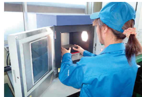
シリコンゴム型を庫内にセット。成形条件を確認後、マイクロ波成形を開始
