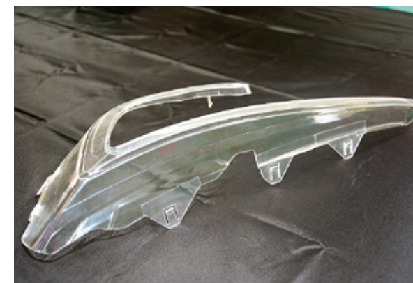
マイクロ波成形+シリコン注型による試作品
