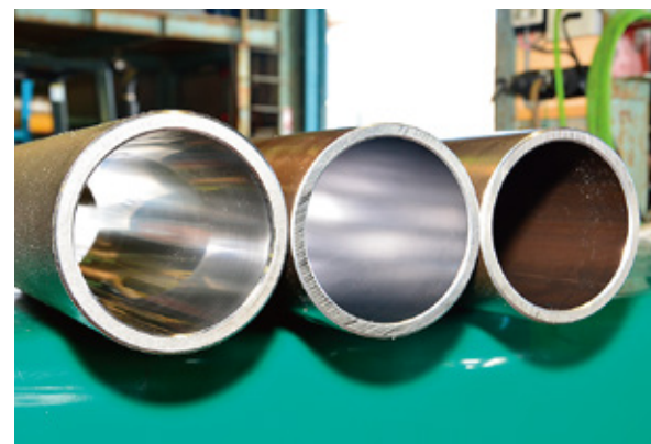
先生の技術が光る、内面を仕上げるホーニング加工
