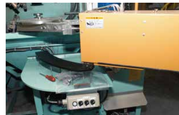
丸鋸の搬入搬出作業自動化を実現したマテリアルハンド
