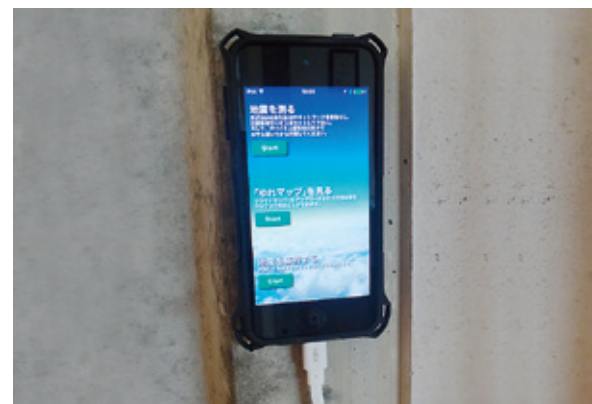
iPhone用に開発した無料アプリケーション「地震」。住宅への設置の様子
