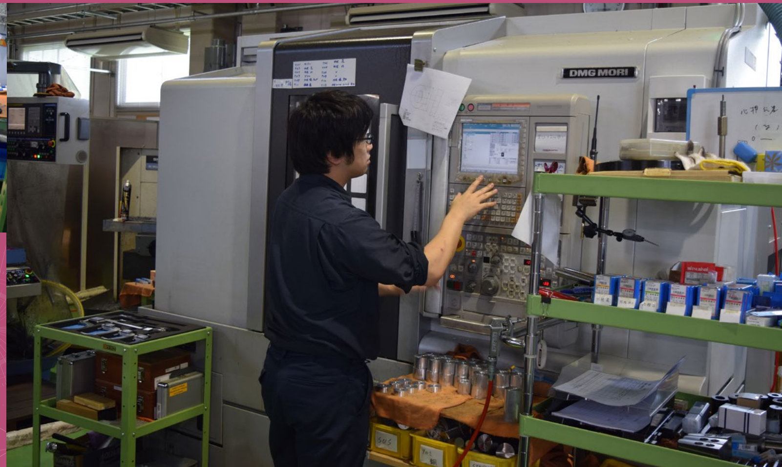
■ 粗加工の内製化を実現した高剛性の複合旋盤
