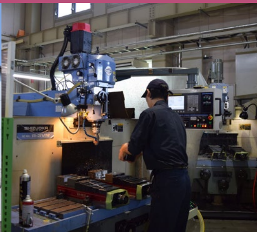
■ 汎用フライスを駆使して金型部品を加工する
