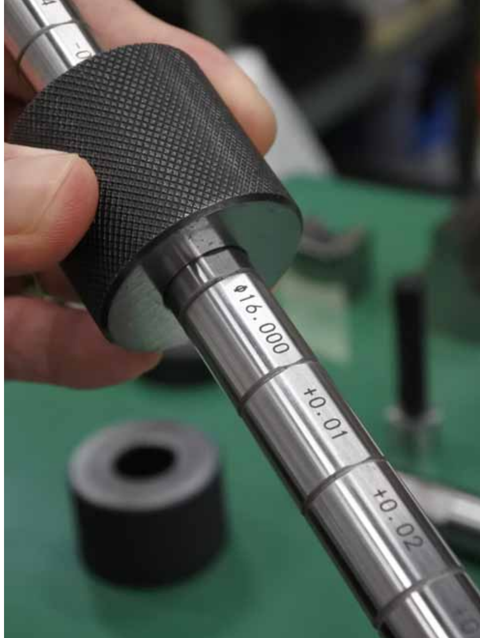
部品の定規と呼べる機器「ゲージ」を手がける。部品形状が複雑になるほど、ゲージ製作も難しくなる
