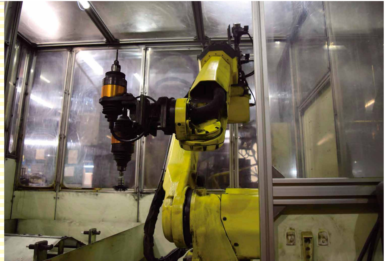
ロボットの活用でバリ取りの自動化を果たし、効率アップとコストダウンにつなげた
