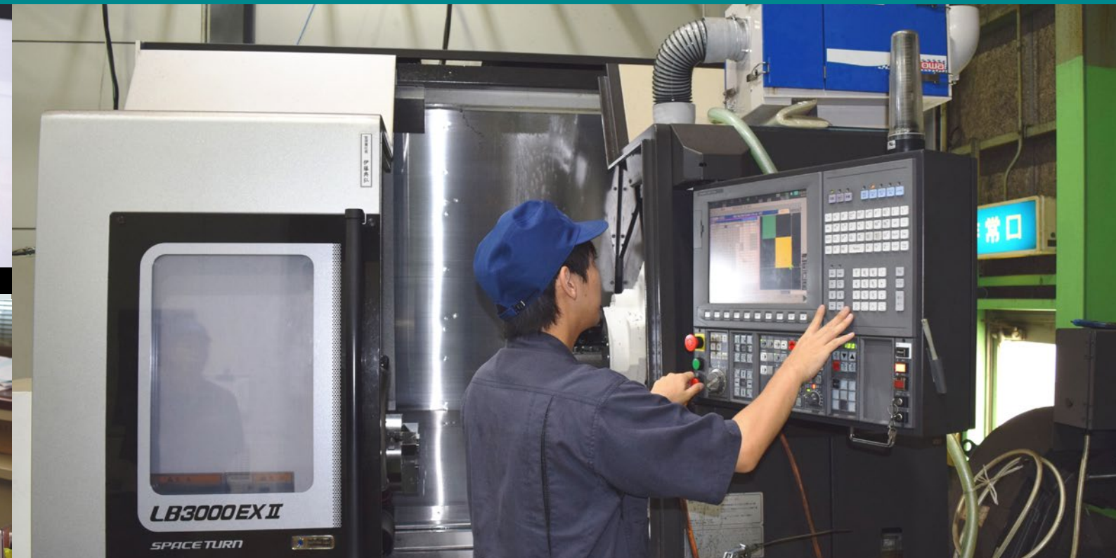
導入したCNC旋盤。周囲の状況に応じて補正するシステムにより、恒温室がなくても高精度な加工ができる
