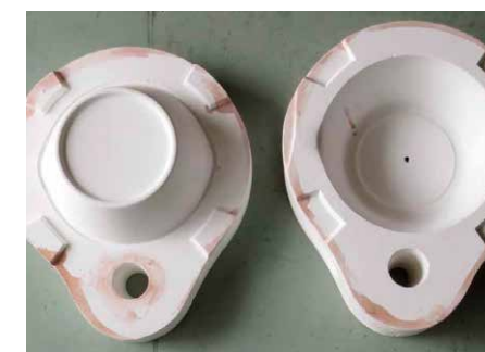
「3 minutes」製造に用いる石膏型
