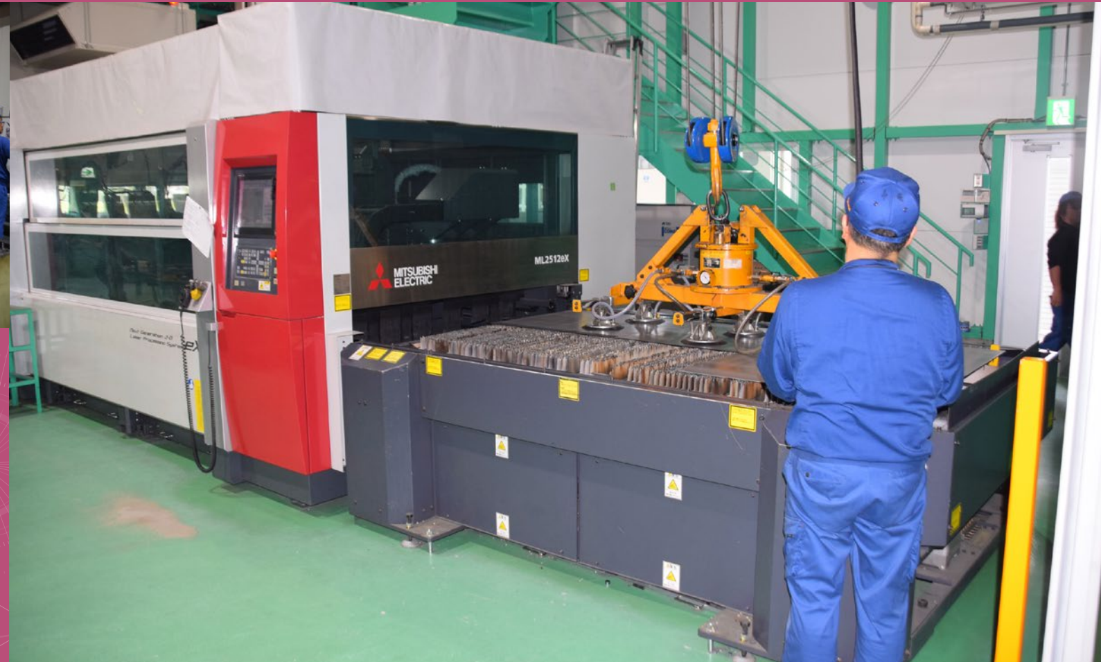
■ 厚物板金加工のスピードアップを実現したファイバーレーザー加工機。
