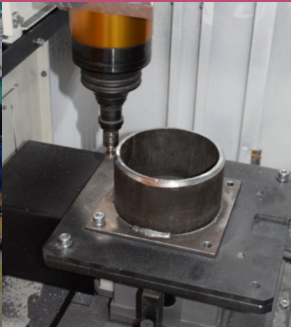
■ 工程集約による高効率化を促進するバリ取りロボットシステム
