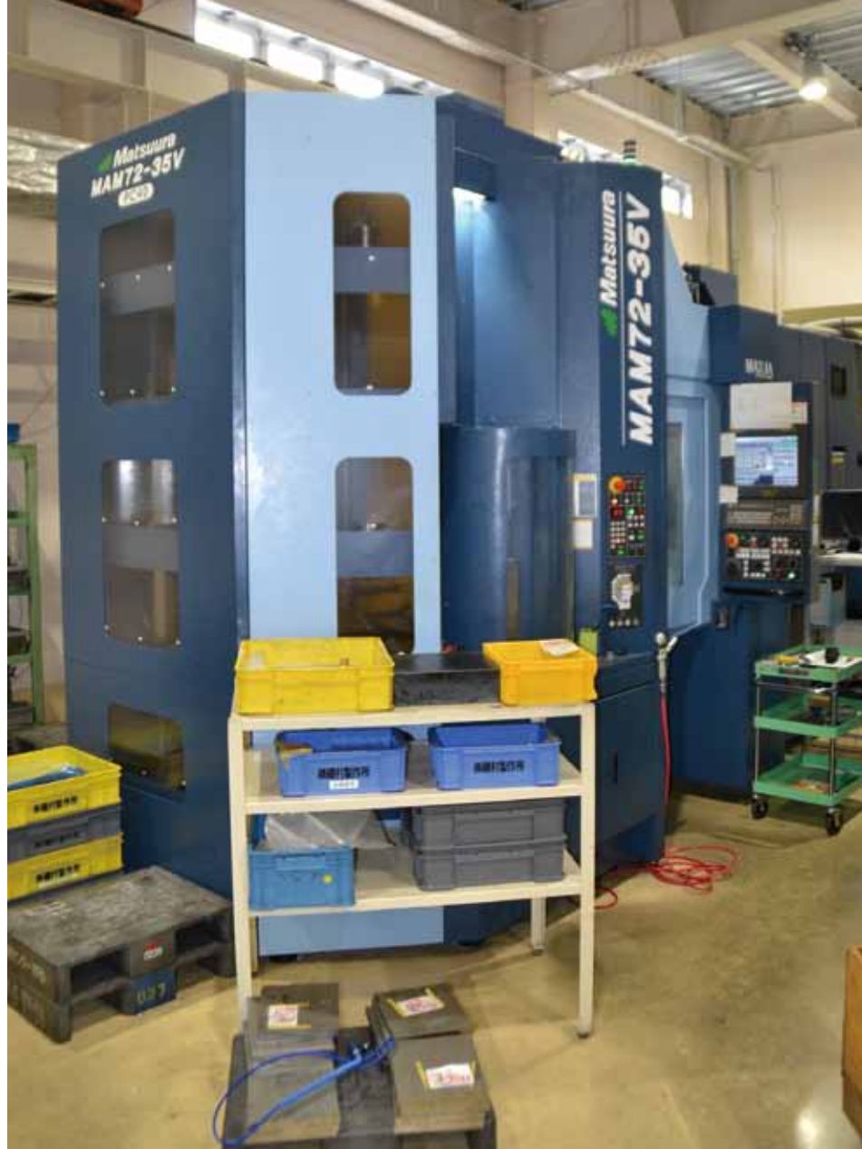
導入した5軸制御の立型マシニングセンター（MC）「MAM72—35V」。生産能力が大幅に向上した
