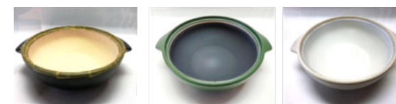
＜超耐熱セラミックス素材へのIH発熱体の溶射実験結果＞
