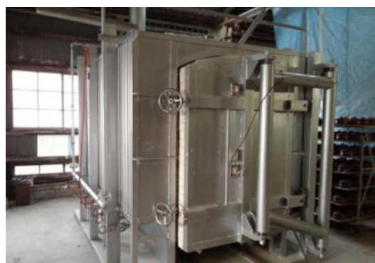
＜導入した素焼き用ガス炉設備＞
