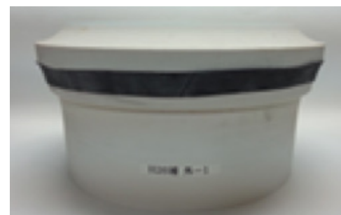
超耐熱セラミックス製耐熱薬膳土瓶 本体底部の石膏型
