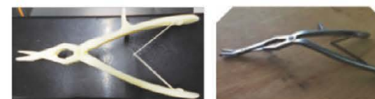
3Dプリンタモデル鉗子と完成した鉗子の試作品
