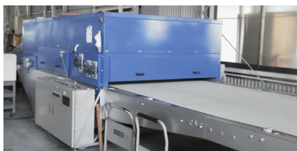
図3 本事業により導入した大型のベーキング乾燥機 （転写前に素材を素早く、ムラなく乾燥させる重要工程で使われる設備）
