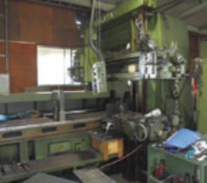
既存設備(大型プレーナー機)改良機
