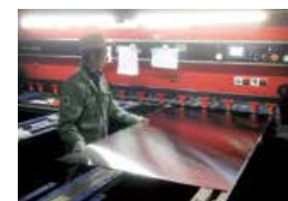
最新型シャーリング機による作業
