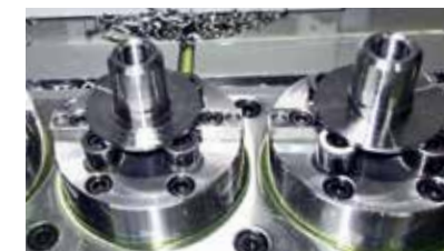
前加工をしたガイドスクリューをMC治具にセットした加工前の状態
