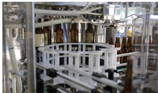
▲一瞬で瓶内を2度真空状態にする
