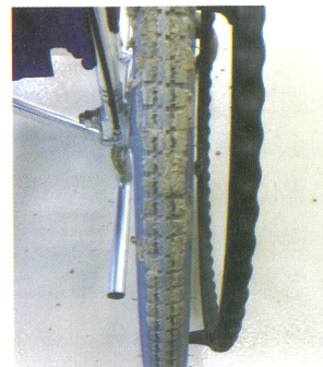
▲「車いす両輪専用洗浄機」で洗浄した車輪(右は洗浄前)
