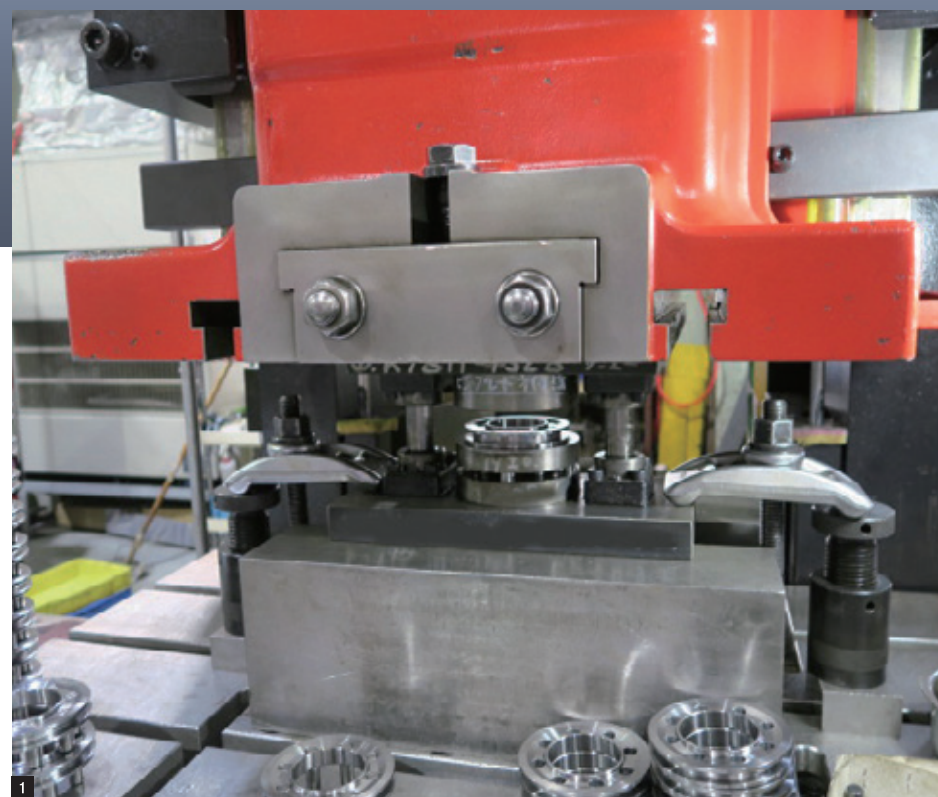
1、2 スライド動作モーションが自由に制御できる新型サーボプレス 3 フクテコの製品
