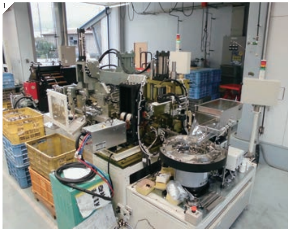
1: 本事業で行なった全自動化。手前半分が今回追加した箇所
