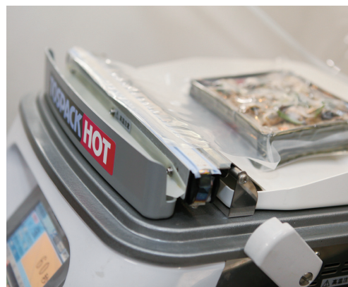
高温状態でバックが可能となる真空包装機
