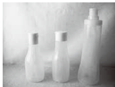
他社逆止弁付容器(左・中)と試作品(右)
