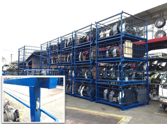
I C タグとネスティングラック
