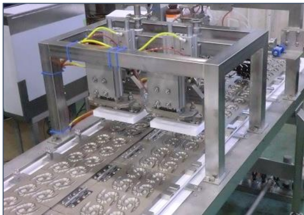
＜イミテーション食品製作の試作機＞ 食品型は海老。特殊な表面加工を施した。
