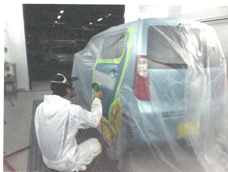
水性塗料ブースでの塗装作業
