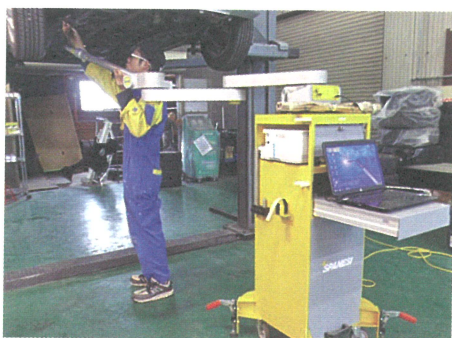
三次元計測機を使った損傷診断
