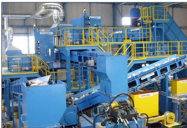
＜導入された光学選別機ライン＞ (2台の選別機を直列に配置して、PE単一・PP単一・混合の3種に分別する。)
