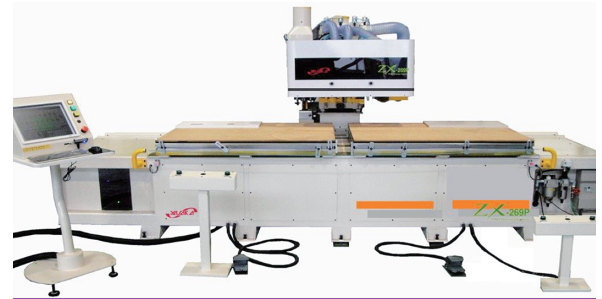
導入設備：PNC複合ボーリングマシン
