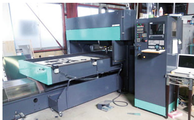
導入設備：レーザー加工機
