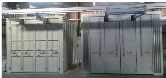
【図1】今回導入した焼付炉・搬送設備
