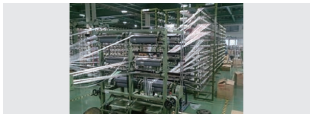
【図2】小福田製作所製 ニードル織機用中間機・クリーラー式
