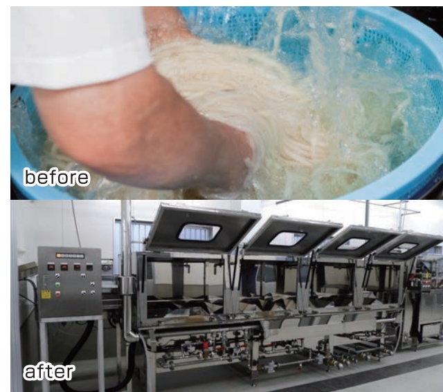
【図1】「自動反転茹で槽」の導入により、従来のように熱いうどんを手洗いがなくなり、身体的負担が軽減した。
