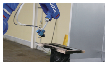
【塗装ロボットによる吹付作業】
