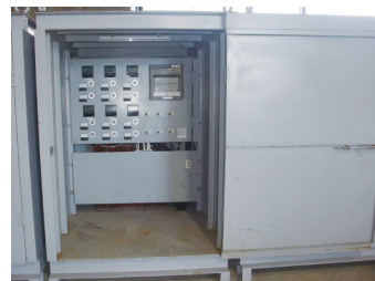
【6点式自動抵抗加熱装置】
