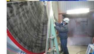
端面塗装作業。人の手作業では塗りムラが生じる（写真左）がロボットで塗るとムラが出ない（写真右）。
