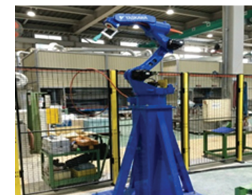
◀ ロボット本体。購入したのは、端面塗装用ロボット2基と粉塵吹き落とし用ロボット1基。
