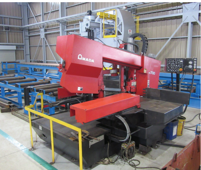
鋼材を切断する装置「形鋼ハンドソー」。
