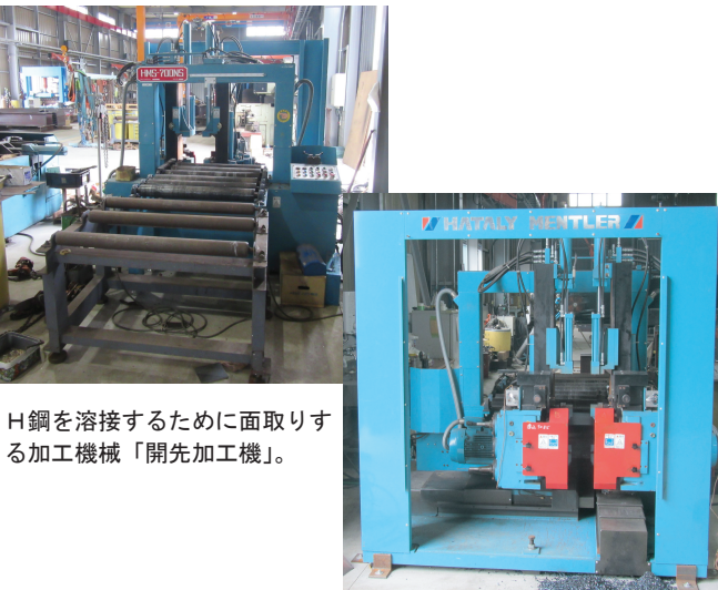
鋼材を切断する装置「形鋼ハンドソー」。
