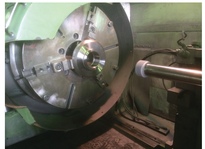
横型研削盤による内面研削盤作業。
