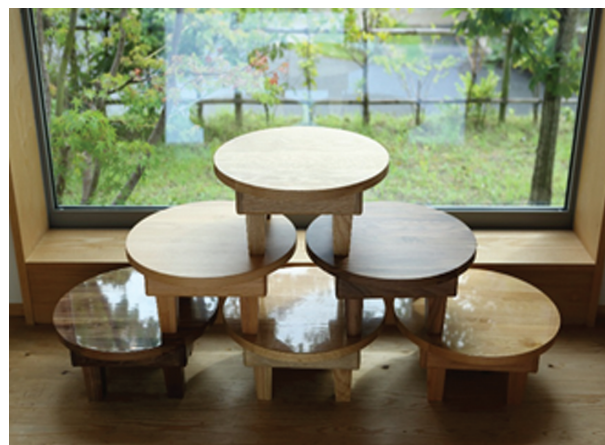
UV 漆鏡面塗装（下 3 台）とUV 艶消し塗装（上 3 台）
