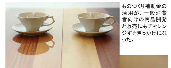
▲ UV 漆鏡面塗装と通常のUV 艶消し塗装の仕上げ比較。
