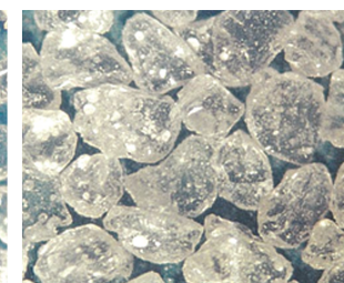
高炉水砕スラグ砂（磨砕後）。形状や大きさが均一になっている。
