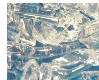
高炉水砕スラグ砂（原砂）。形状や大きさがバラバラ。
