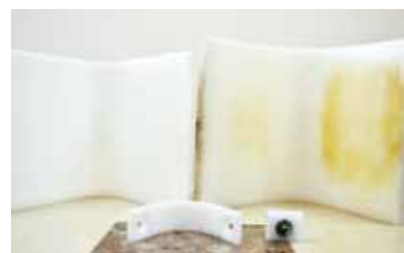
曲げ加工後のUHMW-PE（右は高温で焼けた状態）
